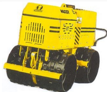
WACKER RT 820 HT kloubový příkopový válec - bezdrátové dálkové ovládání
